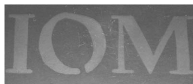
Abbildung 2. Mithilfe von PI-1 hergestellte Poly( 4 )-Beschichtung auf Glas.
